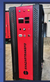
EPC منبع تغذیه DC الکتروکلریناتور شرکت آب و فاضلاب سیستان و بلوچستان توان: ۱۶۰ کیلو وات
