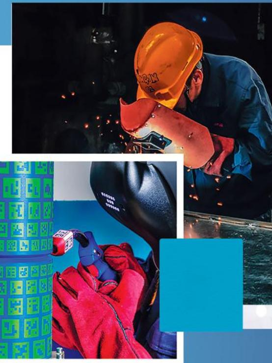
دستگاه شبیه ساز جوشکاری بهمراه کلاه ماسک مخصوص تصویری ترکیبی از نمای واقعی و تصویر کامپیوتربی به نمایش می گذارد و با ارائه محیط تعامل یا مکان باز خورده فوری از عملکرد جوشکار فراهم می آورد که به ارتقاء اصولی تکنیک جوشکاری کمک می کند.
